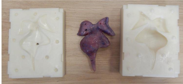
Fig.97 : Partie A et B imprimée en ABS avec tirage silicone en barattage
