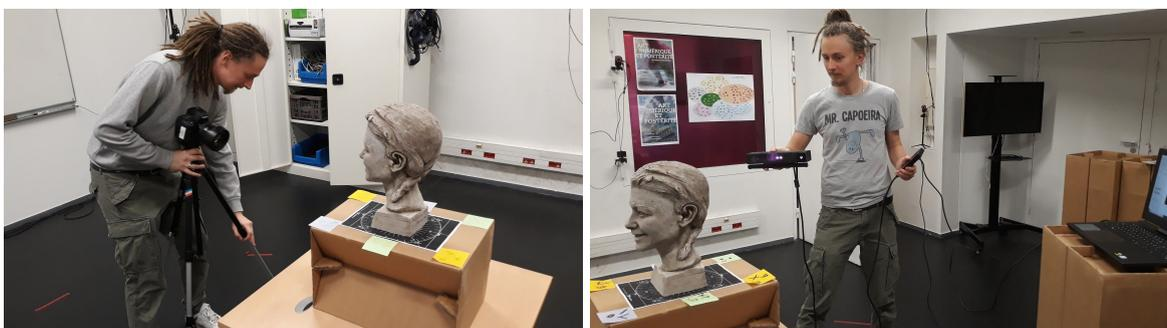
Ce test montre donc les différences de qualité, en fonction de la technologie à éclairage égale, mais sur un objet de 40 cm. Un temps court passer sur un objet peut être intéressant, même si la qualité est moindre vis à vis du type d'utilisation du scan. Si une production ou une mission nécessite de numériser en quantité, l'application mobile ou la Kinect seront plus adaptés que la photogrammétrie.
