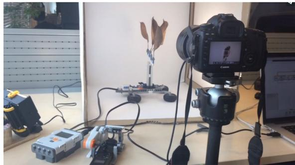
Fig.52 : Photogrammétrie de feuille avec interface Lego
