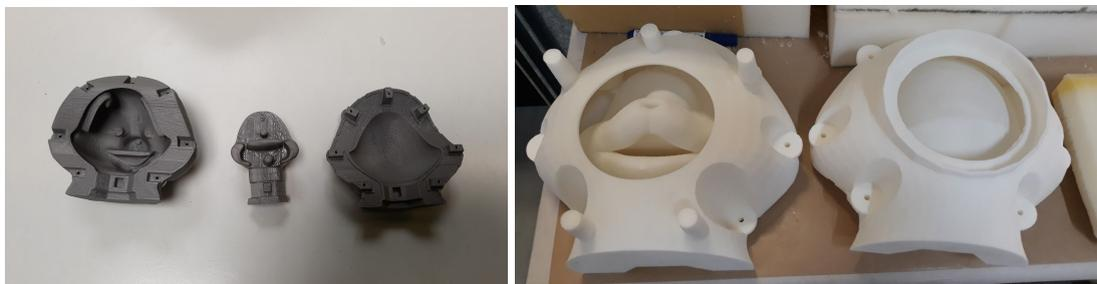
Fig.108 : Prototypage moule imprimé (2019) par Moving Puppet échelle 1/3
