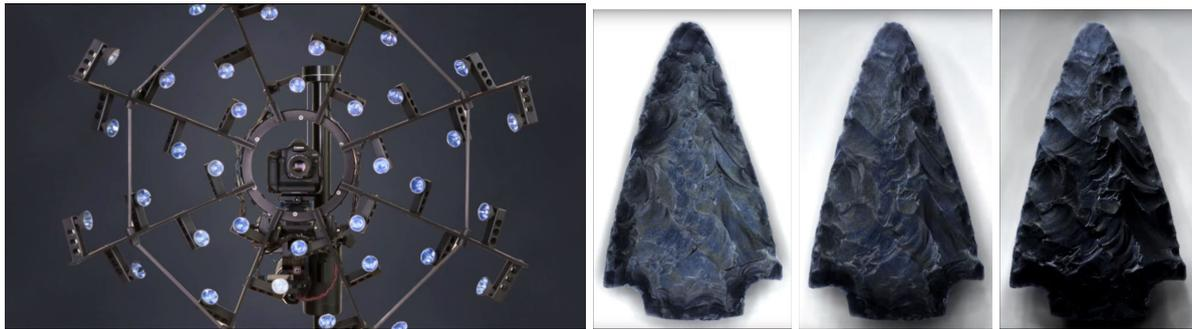
Fig.28 : Installation lumière et caméra pour réaliser un rendu en RTI - Chimaging (2010)
